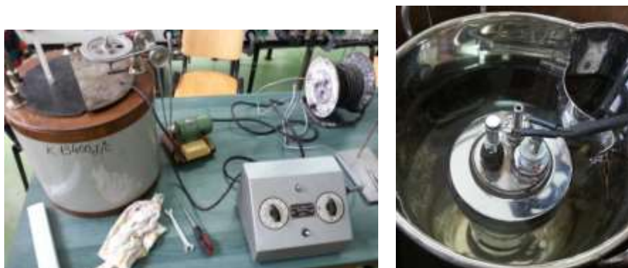
Fig. 3 Măsurarea căldurii de ardere superioare stânga: montaj experimental bombă calorimetrică, dreapta: imagine cu bomba calorimetrică imersată în apă în vasul izolat
