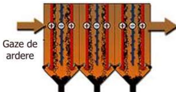
Fig. 12 Modalitate funcționare filtru electrostatic [13]
