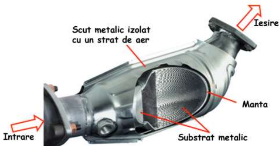
Fig. 2 Convertor catalitic metalic cu trei căi (Emitec GmbH) [4]
