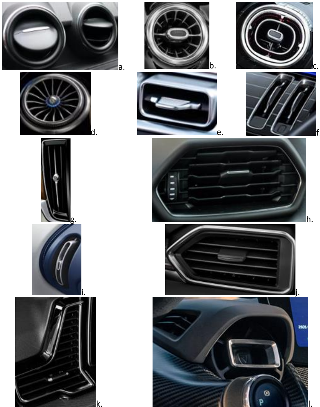
Figura 2 Diferite tipuri de difuzoare de aer de bord a. Dacia Duster 2022, b. Mercedes clasa A 2022, c. Mercedes clasa C 2022, d. Mercedes EQS 2022, e. Mercedes clasa S 2022 (zona centrata), f. Mercedes clasa S 2022 (zona laterala), g. Volvo S/V90 2022, h. Lamborghini Huracan Evo 2022, i. Bugatti Chiron 2022, j. Mazda CX5 2022, k. Kia Sportage 2022, l. Rimac Nevera 2022
