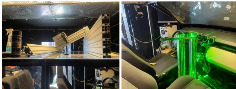
Figura 27 Configurație experimentală și calibrare măsurări PIV
