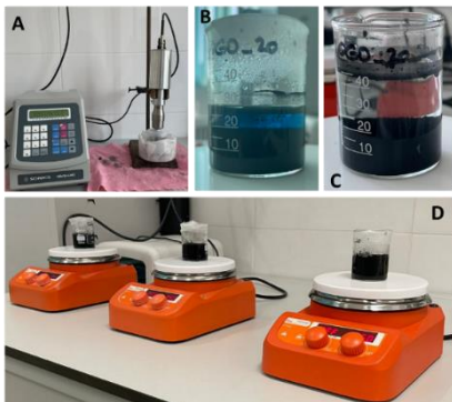
Figura 11: Imagini digitale reprezentative pentru protocolul de decorare: A) Dispersarea GO în apă; B) Dispersia Cu@GO_{20} înainte de spălare; C) Dispersia Cu@GO_{20} după spălare; D) agitarea puternică a dispersiei GO după adăugarea de CuSO_4 în trei concentrații (20%, 10% și respectiv 5%)
