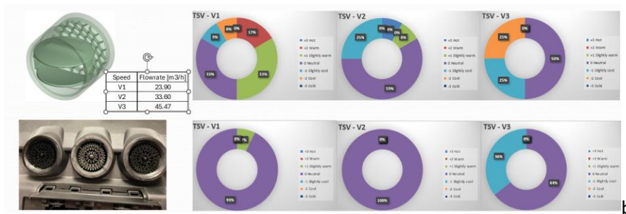
Figura 19 a. Colaj cu o parte din participanții studiului cu subiecți umani pentru evaluarea celor două difuzoare de aer în habitacul de autovehicul construit în celula climatică b. Rezultate studiu cu subiecți umani – Sus – Rezultate pentru aeratorul Dacia-Renault Duster, Jos – Rezultate pentru aeratorul inovativ
