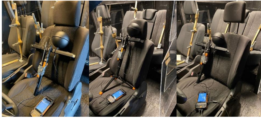
Figura 18 Imagini cu echipamentul TESTO 480 amplasat in diferite zone pe scaunul șoferului
