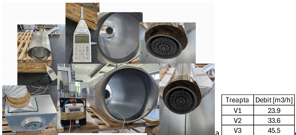
Figura 13 a. Colaj cu imagini din timpul măsurărilor acustice b. Trepte debit
