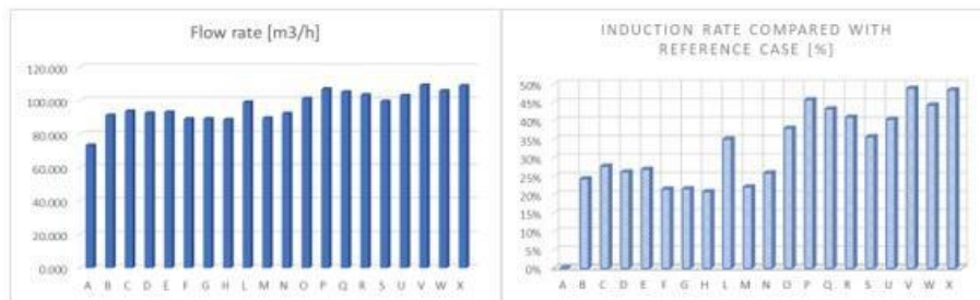
Rata de inducție pentru difuzoarele de aer studiate la 600 mm de la planșa de bord: Stânga – Debit volumic la 600mm, Dreapta – Rata de creștere a inducției curentului de aer.
